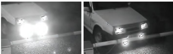
Рис. 2. Результат засветки фарами автомобиля
