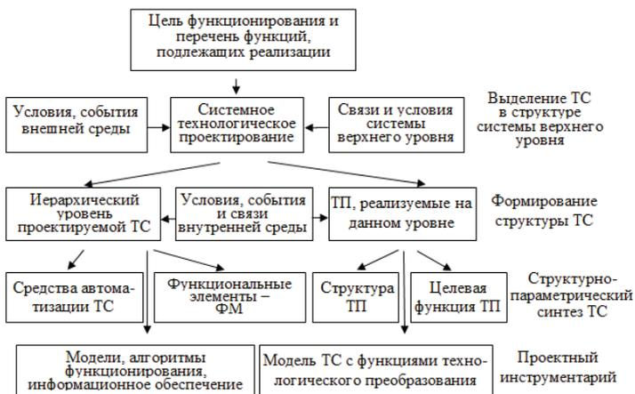
Рис. 2. Структура и элементы системного технологического проектирования
