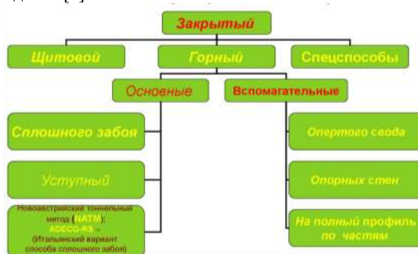
Рисунок 1 – Способы строительства тоннелей
