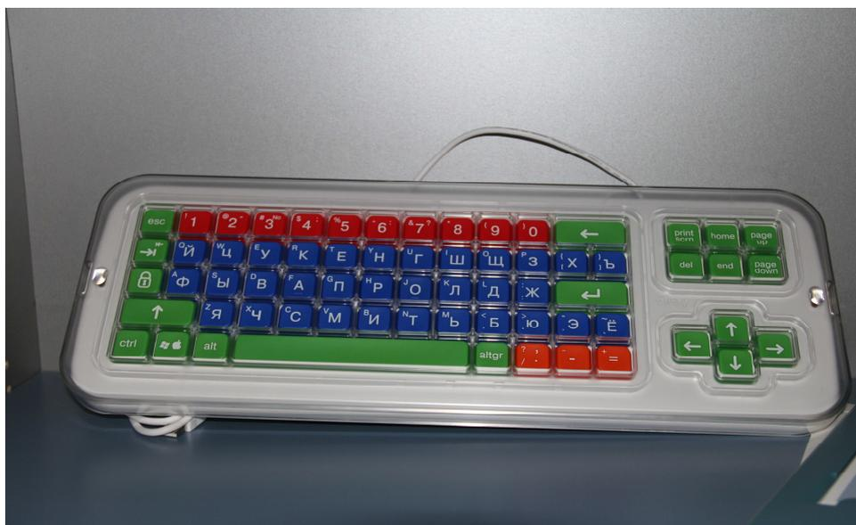
Рисунок 1 – Специально разработанная клавиатура для лиц с нарушением координации рук
