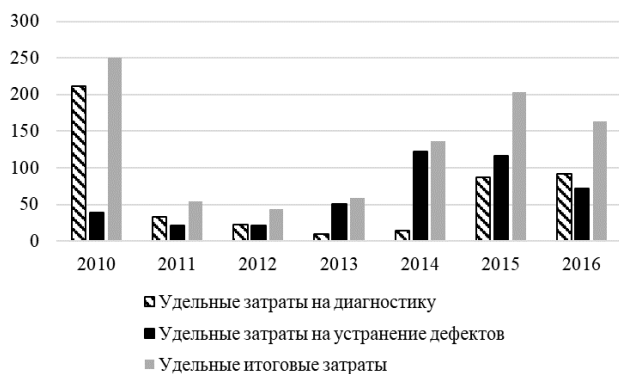
Рисунок 1 - Удельные затраты по устранению дефектов на магистральном газопроводе «Ямбург-Елец1» протяженностью 1150 км в 2010-2016 гг., тыс. руб. / ед.
