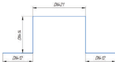
Рисунок 8 – Схема экспериментального участка с П - образным переходом
