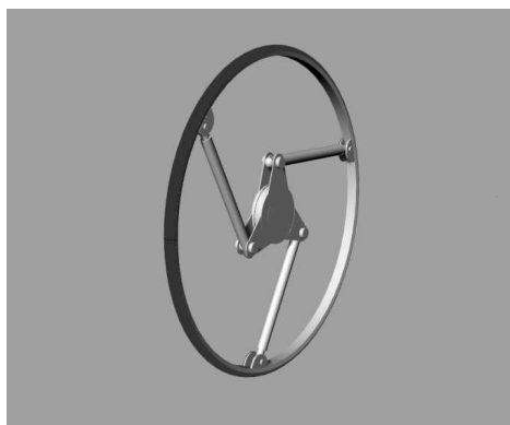
Рис. 3. Конструкция SOFTWHEEL колеса и амортизатора
