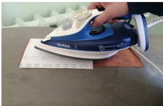
Рис. 3. Перенос рисунка на стеклотекстолит
