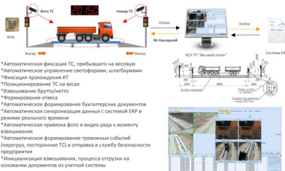
Рисунок 4 – Возможности «Автоматизированная система управления технологическим процессом «Весовой поток»» при отгрузке готовой продукции
