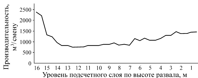
Рис. 2. Изменение производительности с понижением с понижением уровня забоя драглайна.
