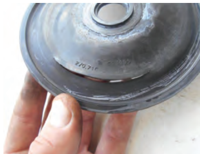
Рисунок 2 – Сквозной разрыв диафрагмы воздухораспределителя № 483
