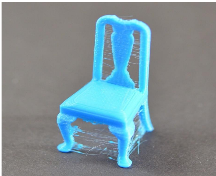
Рис. 5. Нити от излишков пластика остающихся на сопле
