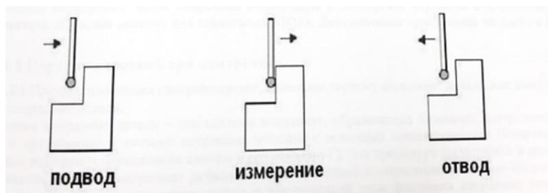
Рисунок 4 – Цикл измерения координат точки
