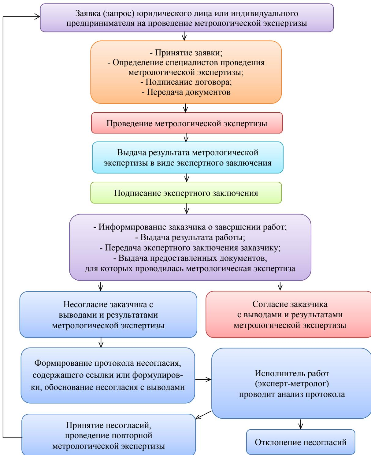
Рисунок 1 – Последовательность процедуры проведения метрологической экспертизы
