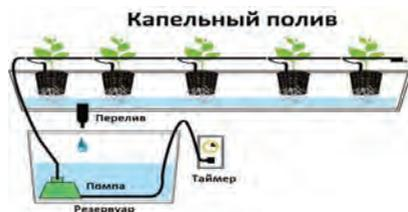
Рисунок 4 – Система капельного полива
