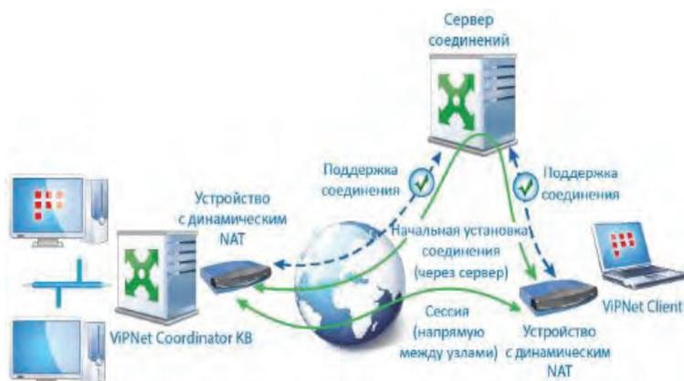
Рисунок 2. Подключение координатора через межсетевой экран с динамической трансляцией адресов
