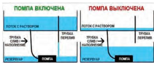
Рисунок 3 – Система периодического затопления
