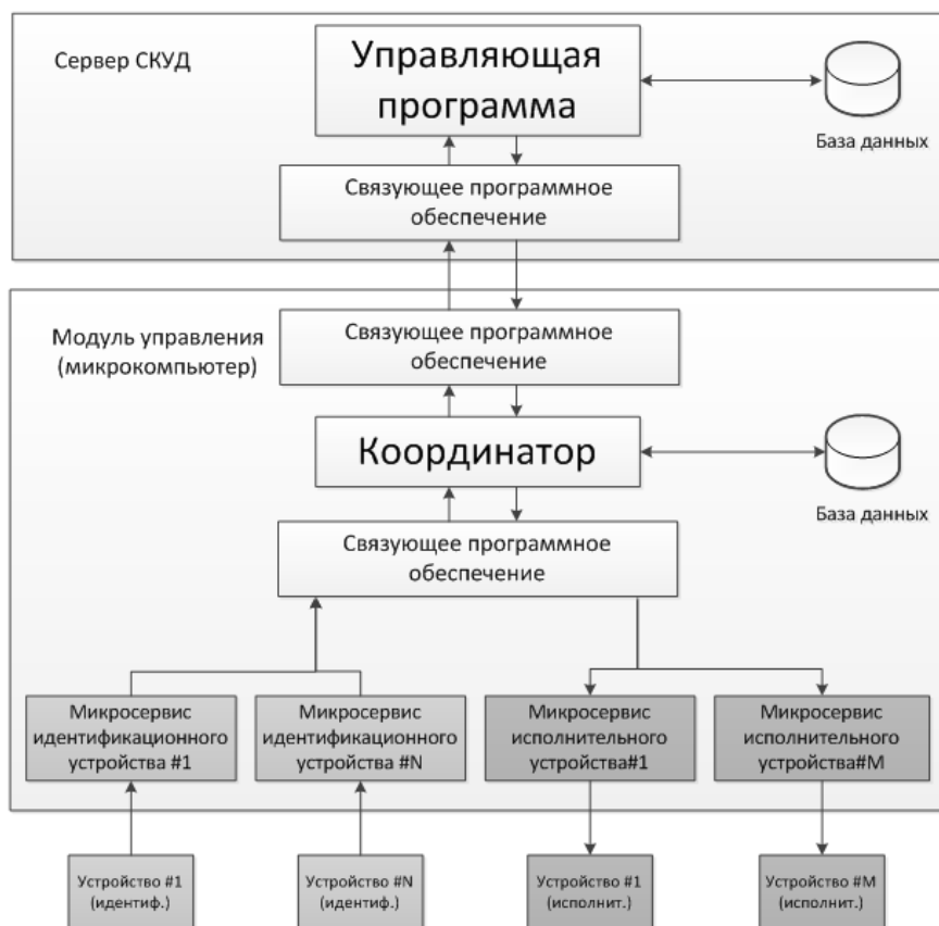
Рис. 1. Схема архитектуры СКУД на базе программно-аппаратного комплекса
