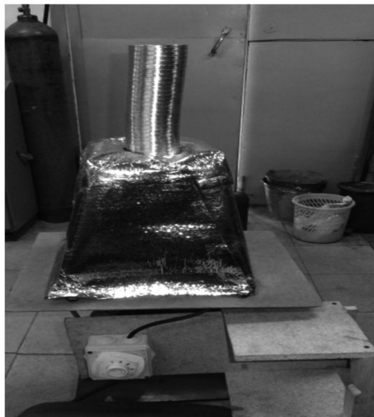
Рис. 4. Стенд исследования поглощения инфракрасного излучения базальтовым покрытием
