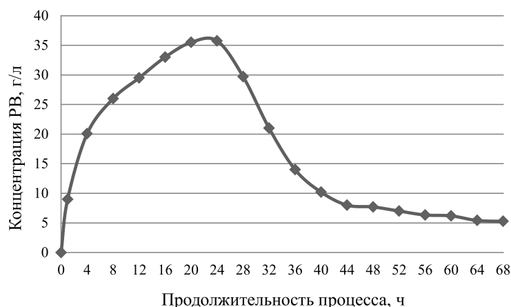
Рис. 2. Зависимость концентрации РВ от продолжительности процессов ферментативного гидролиза и спиртового брожения ВП плодовых оболочек овса
