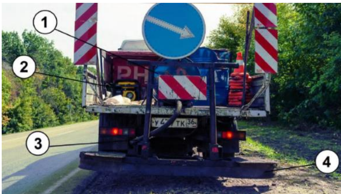
Рис. 1. Общий вид автомобиля с механизмом приготовления гидрофобного состава с кинематической вязкостью более 70 \text{ мм}^2/\text{с} : 1 – емкость (бочка) с пропиточным составом; 2 – электрогенератор с компрессором; 3 – распределительное сопло; 4 – разглаживающая рейка
