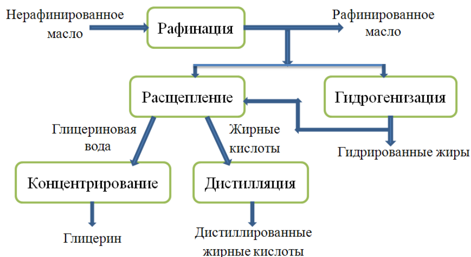
Рисунок 5. Блок-схема производства и переработки различных видов масел с выделением конечных продуктов
