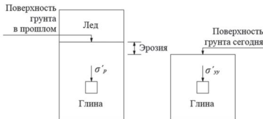
Рис. 1. Формирование переуплотненных грунтов, где \sigma'_p — максимальное вертикальное напряжение в прошлом; \sigma'_{yy} — текущее бытовое напряжение
