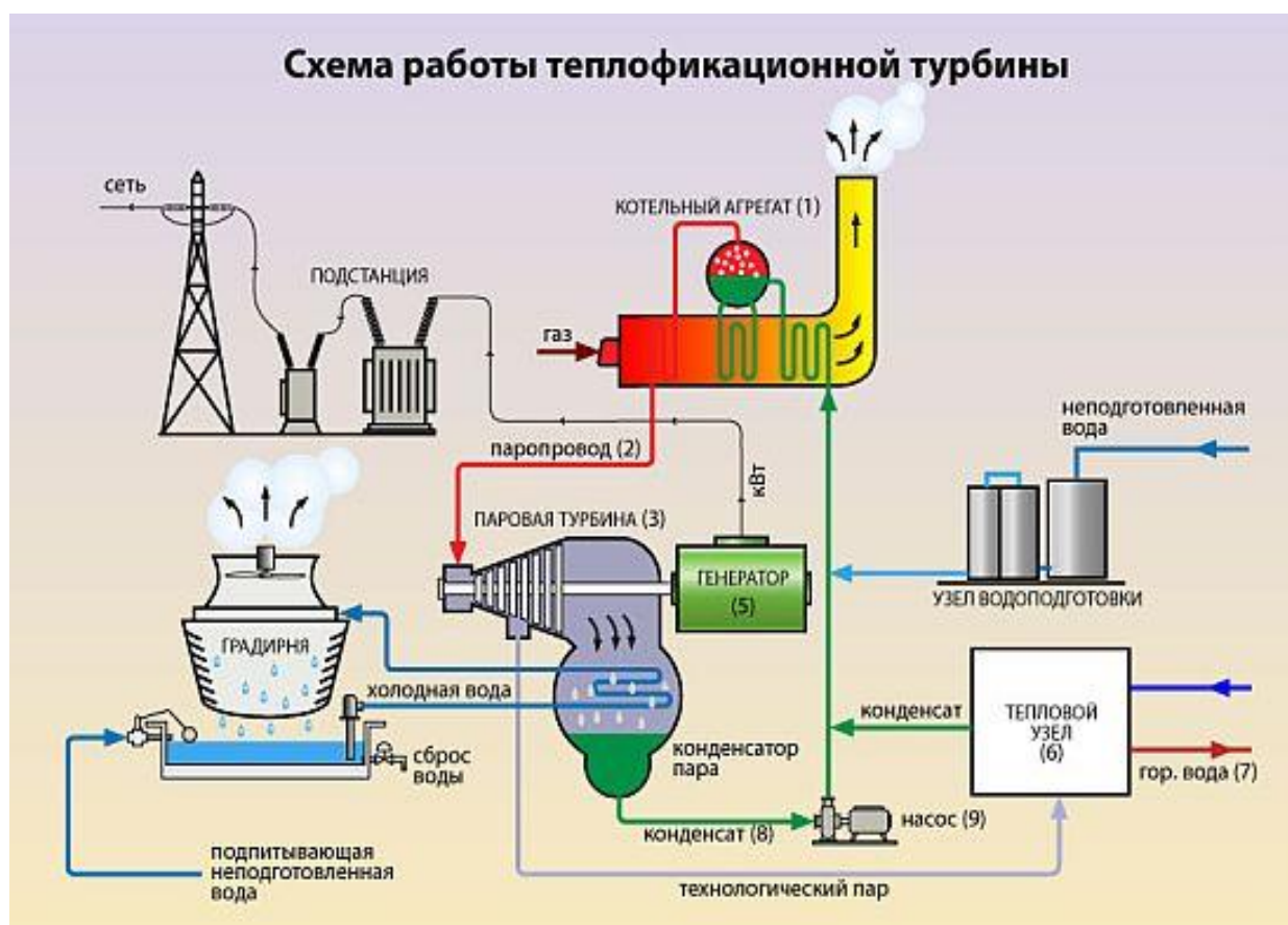
Рис. 4. Схема работы паровой теплофикационной турбины
