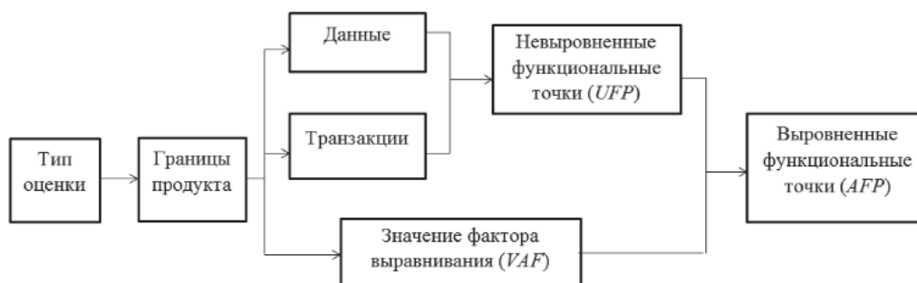
Рис. 1. Процедура оценки функционального размера по методу ФТ
