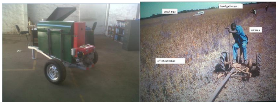
Рис. 1. (а) молотилка, (б) режущий аппарат в работе резка сои
