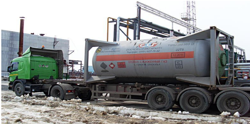
Рис. 1. Прицепные крио-контейнеры для перевозки СПГ
