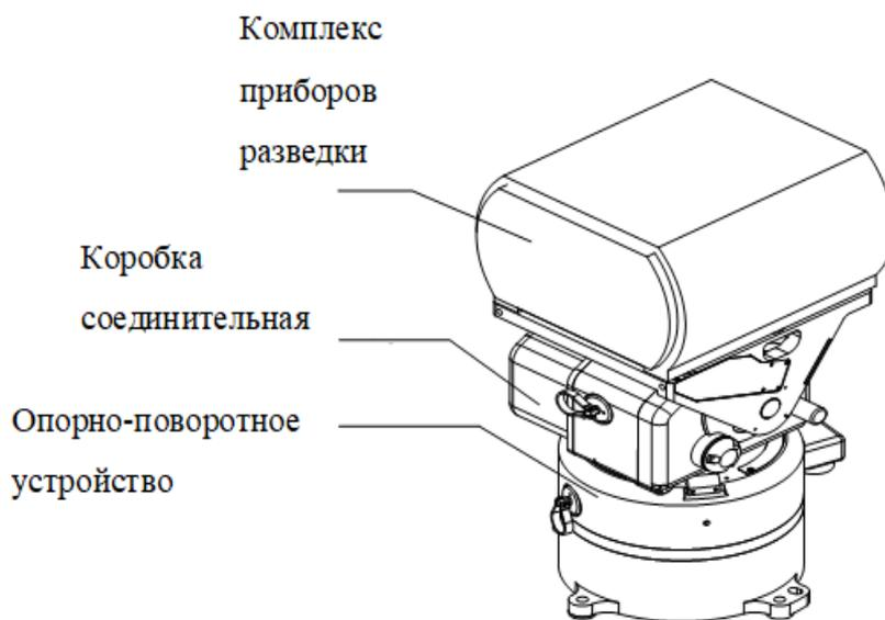
Рис.1. Система наведения приборов разведки
