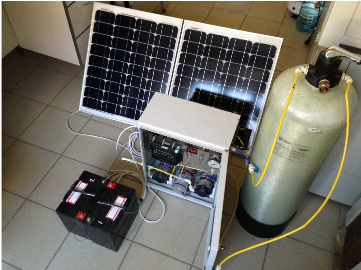
Рис. 1. Мобильная обратно-осмотическая установка с питанием от солнечных панелей
