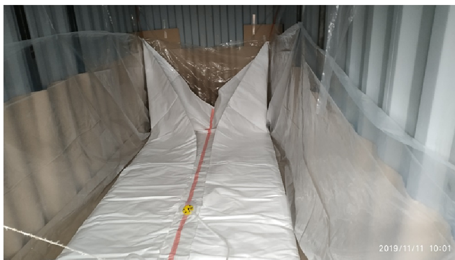
Рис. 1. Контейнер, оборудованный флекситанком, перед заливкой груза
