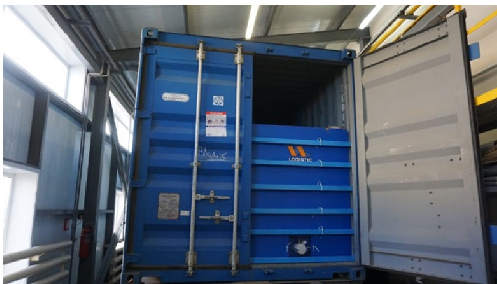
Рис. 2. Щит с защитными балками
