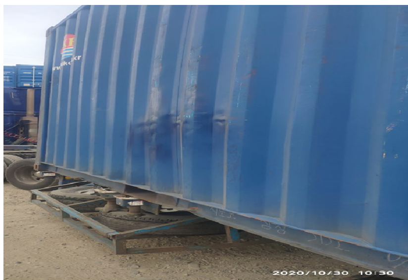
Рис. 3. Выгибание стен контейнера
