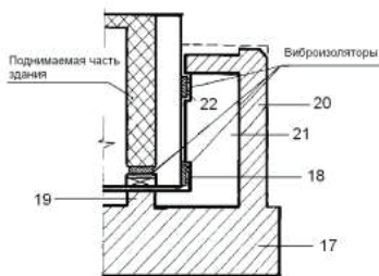
Рис.3. Схема виброизоляции цокольного этажа в основании здания.
